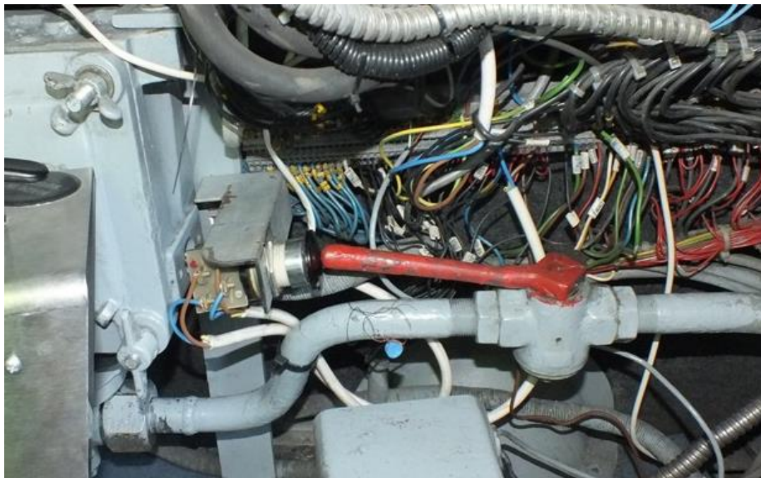
2. ábra: a szakadt plomba (a szelepkar és az általa tartott nyomógomb egymáshoz képest elmozdítható volt)
