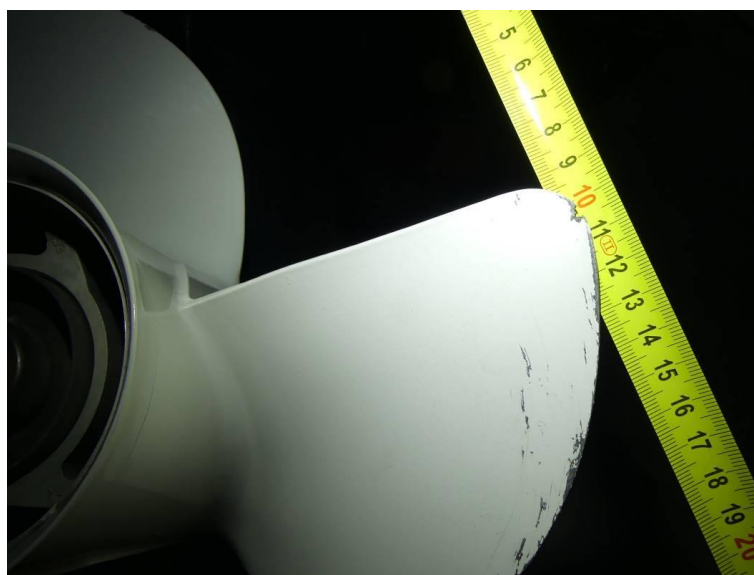
3. ábra: Sérülésnyomok a hajócsavaron
