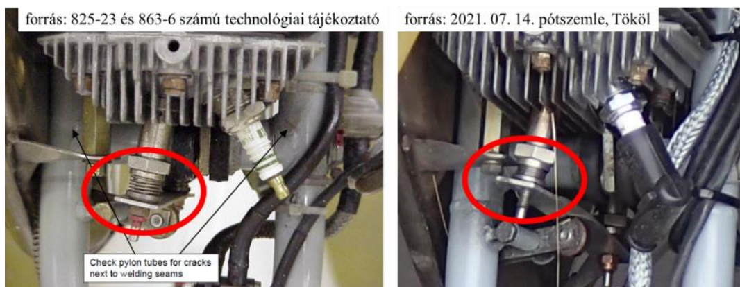
16. ábra: a hiányzó dekompresszor-szelep rögzítőanya
