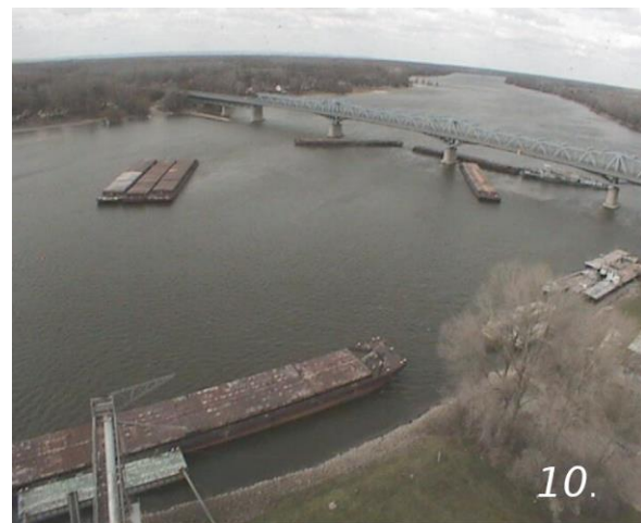
5. A csatolókötelek elszakadtak, a bárkák leváltak a hajókötelékből.
