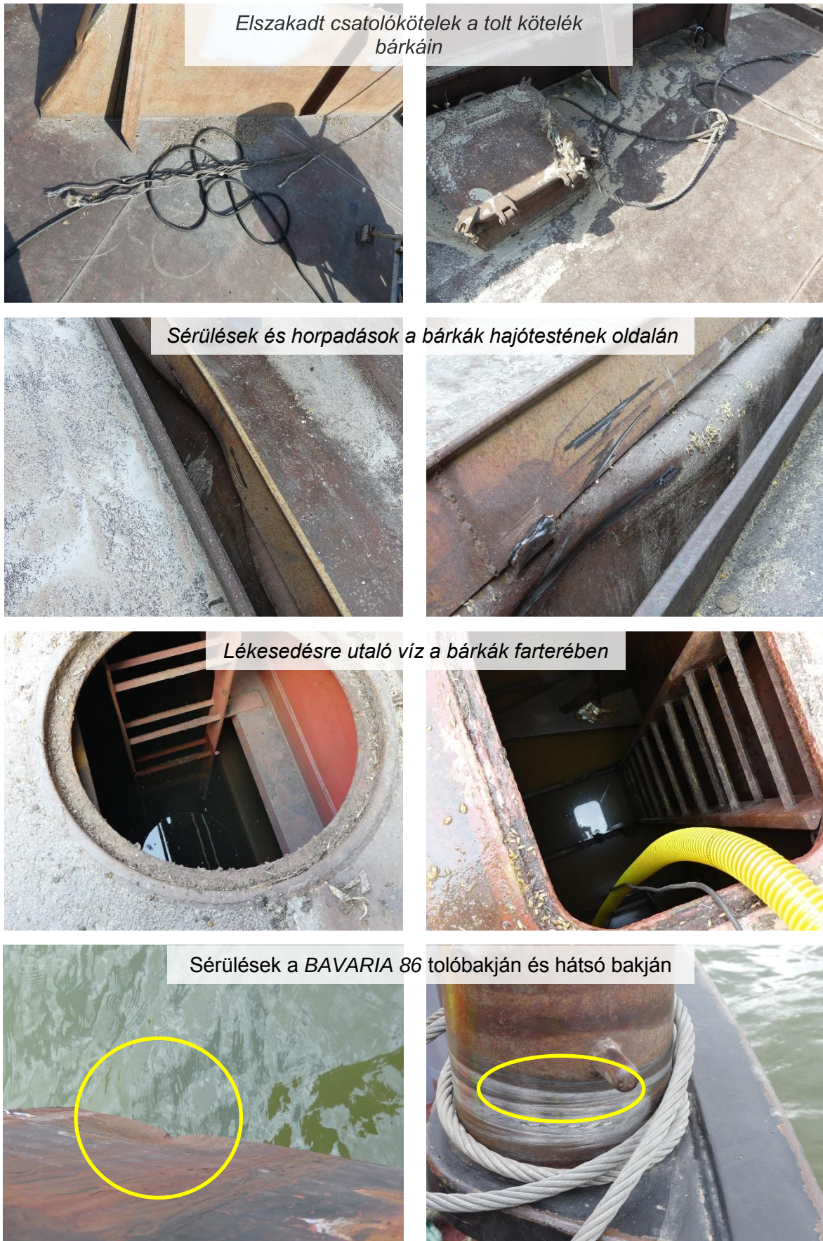
11. ábra: A balesetben érintett úszólétesítményeken keletkezett sérülések
