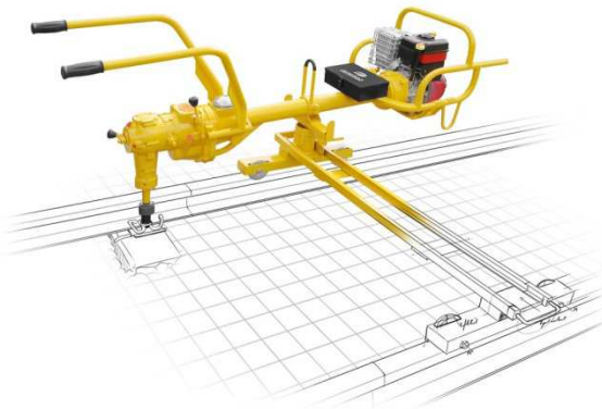
4. ábra: Geismar Bolt Hornet TS2 típusú síncsavarozó gép (forrás: Geismar.com)
