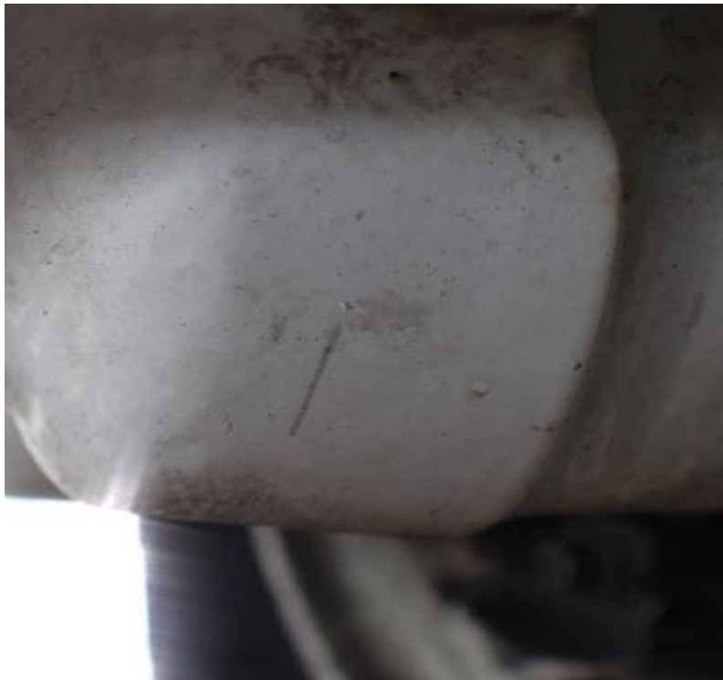
13. ábra - Karcolás a bal oldali főfutószár alsó részén (HA-YFJ)
