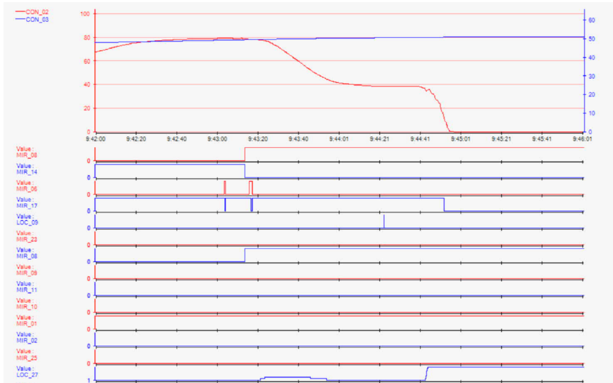
5. ábra: a vonat menetadatai (CON_02 = sebesség, MIR_08 = EVM ---, MIR_14 = EVM MAX)
