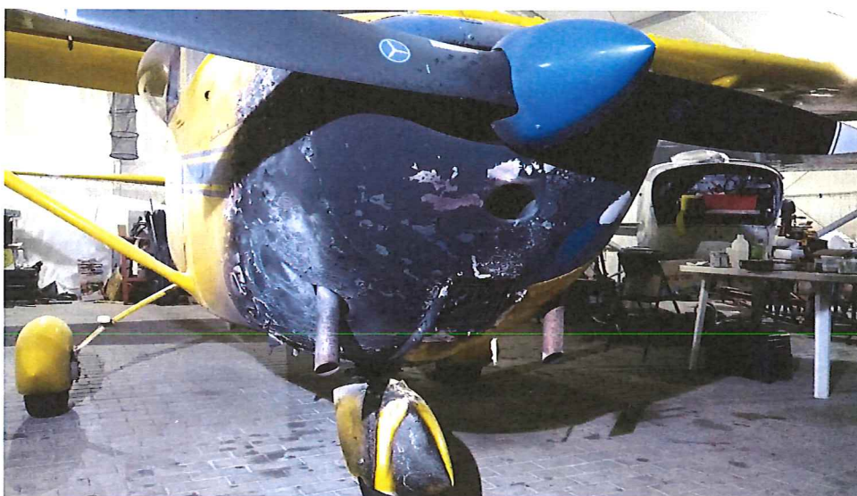
1. kép: A motortértűz külső jelei a légijárművön
