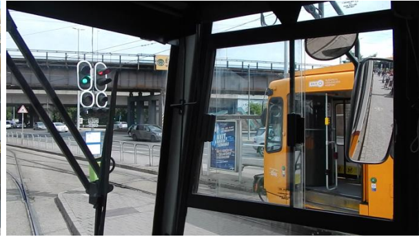
10. ábra: a jobb oldali tükörbe tekintő járművezető látómezeje, amikor a II. vágányon álló villamossal (annak elindulása előtt) nagyjából egy vonalba ér 4
