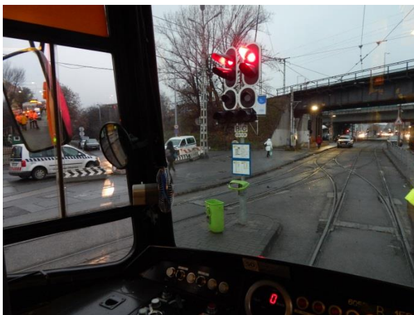
8. ábra: a „B” és „C” jelzők láthatósága a II. vágányról pár méterrel hátrébb állva
