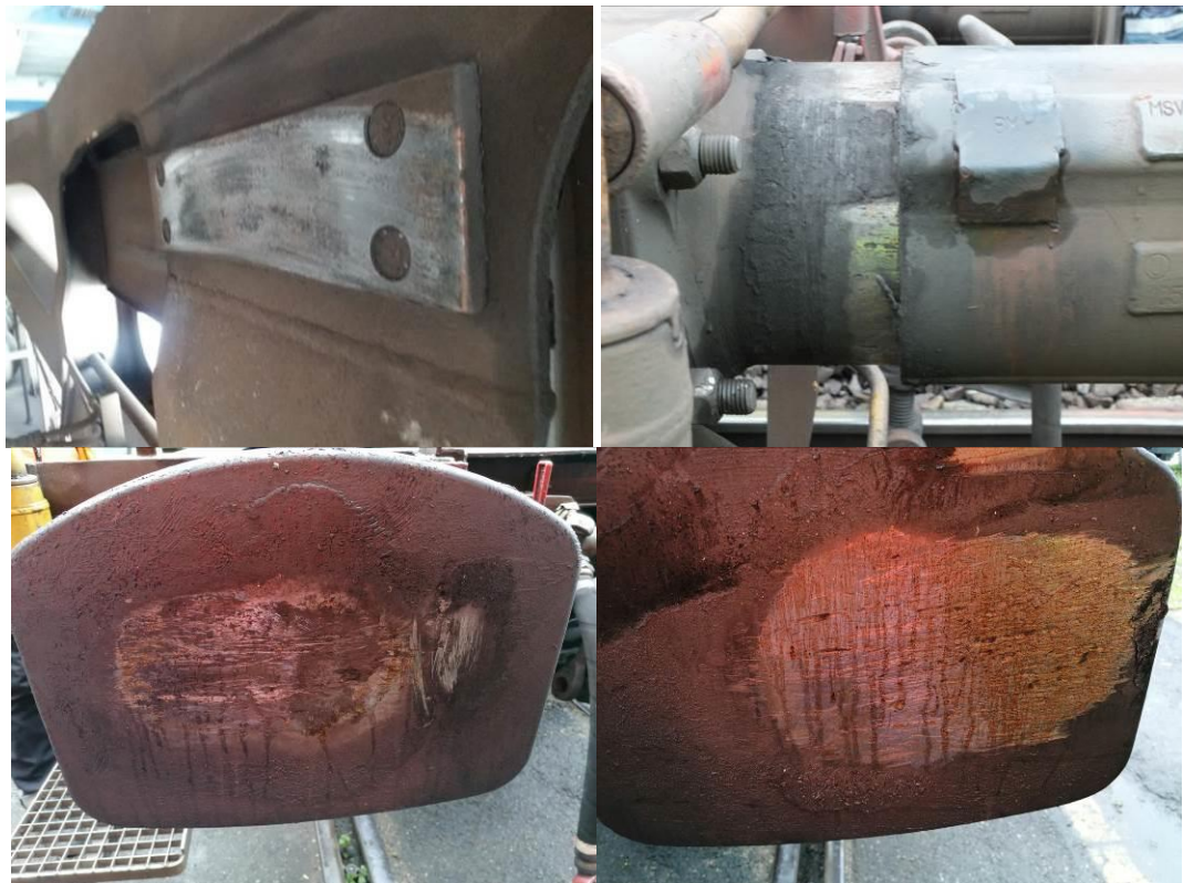
6. ábra: a járművek kenetlen alkatrészei
