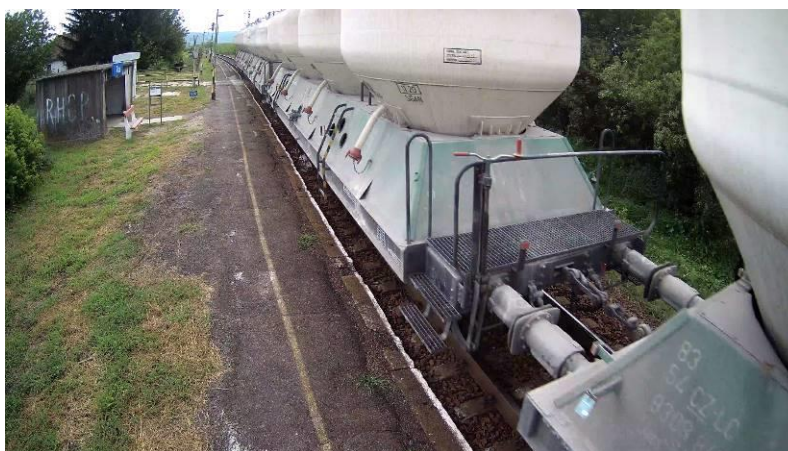
15. ábra: A kameraképen nem látható, hogy a siklott kocsiknak bármilyen sérülése lenne
