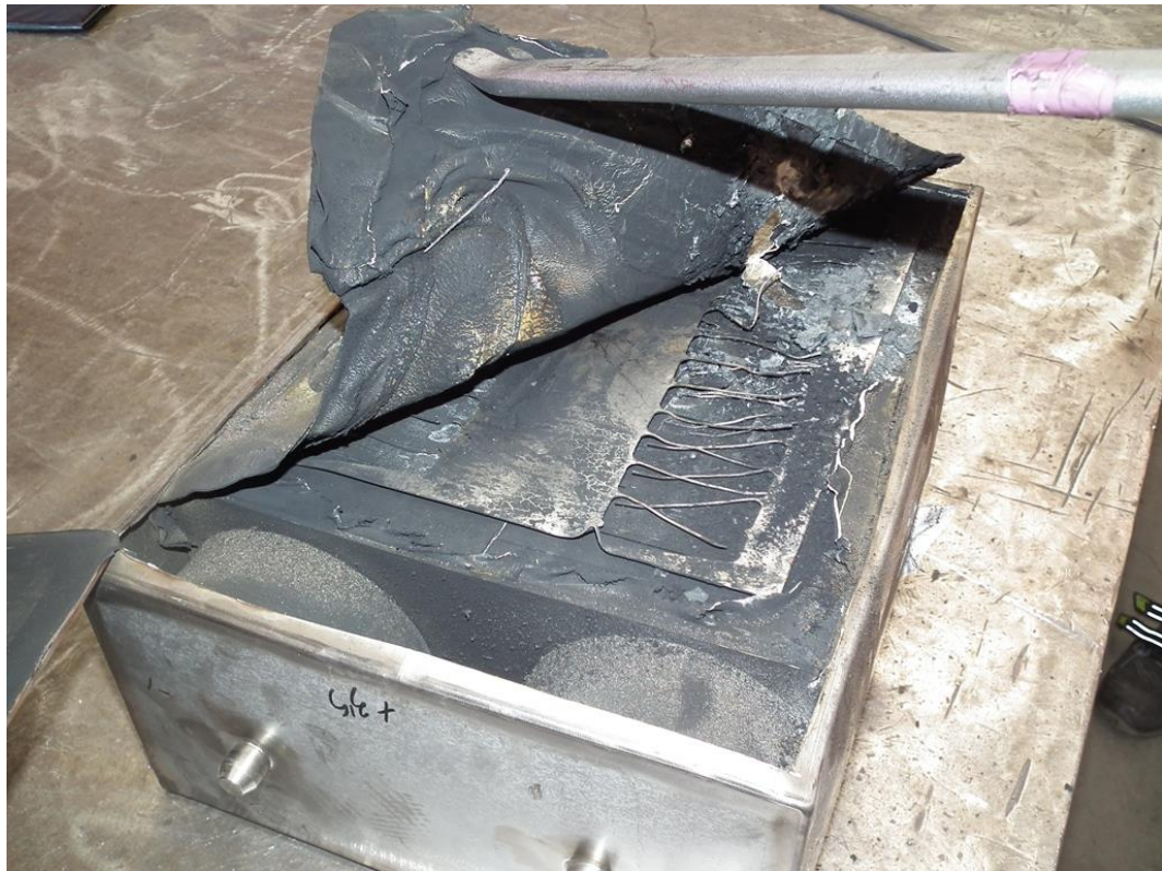
2. ábra: a kondenzátor belseje
