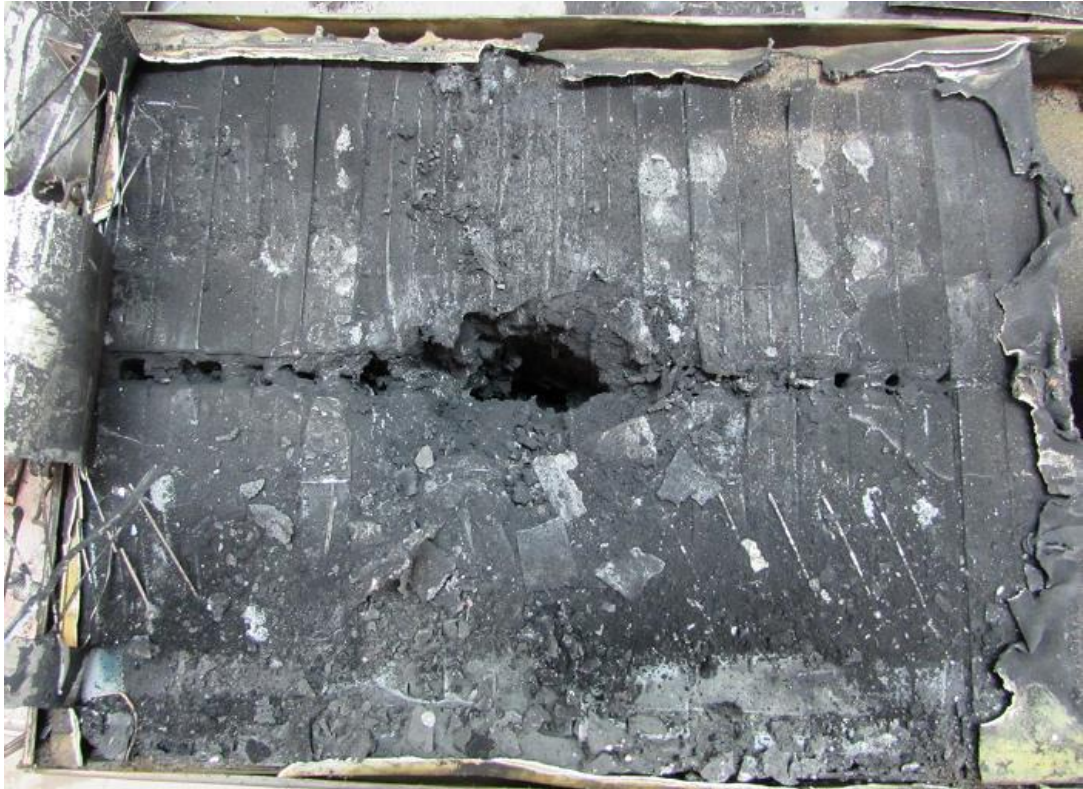
3. ábra: a C2 kondenzátor állapota
