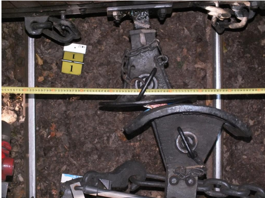
7. ábra: az kapcsolókészülékek helyzete a helyreállítást követő próba során, 240 mm csapszegtávolság mellett: az ütközőfelületek alsó része összeért
