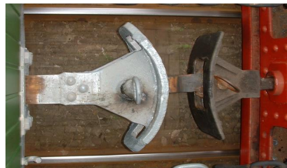
2. ábra: a keskenynyomközű vasutak jellegzetes kapcsolókészüléke
