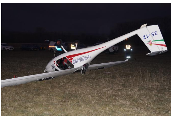
2. ábra: A repülőgép helyzete és az elhajlott féklapok
