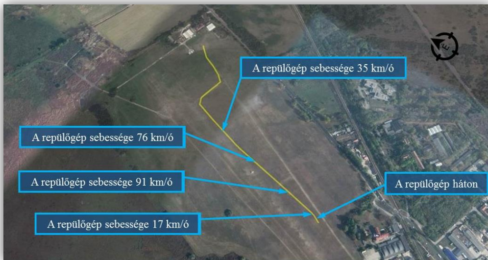
1. ábra: A repülőgép útvonala és sebessége a fedélzeti GPS alapján
