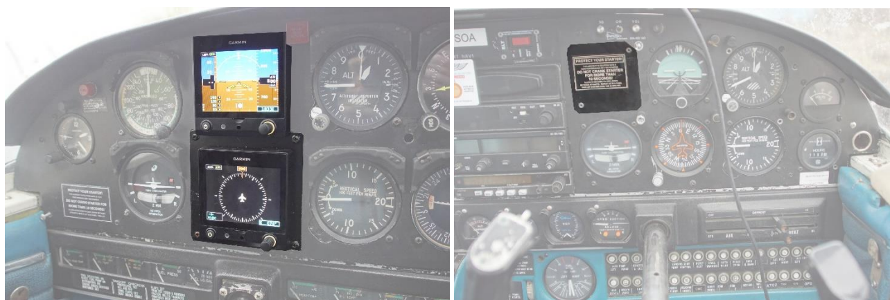
2. ábra - bal oldali G5-beépítés és a jobb oldali kiszertelt ASI (fotó: KBSZ)
