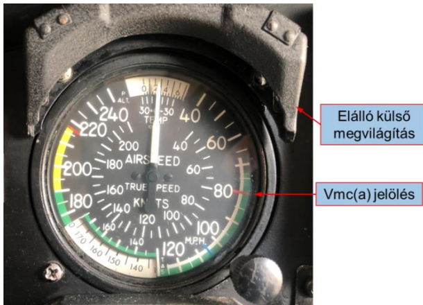
5. ábra - a bal oldali sebességjelző számlapja a Vmc(a) jelöléssel (vörös vonal, 80 mph) és az elálló műszervilágítás
