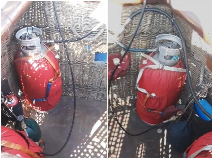
16. ábra: az eseményben érintett kosár elrendezése közvetlenül a felszállás előtt
