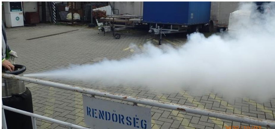
6. ábra: a gáz kiáramlása a tartályból nyitott csap esetén
