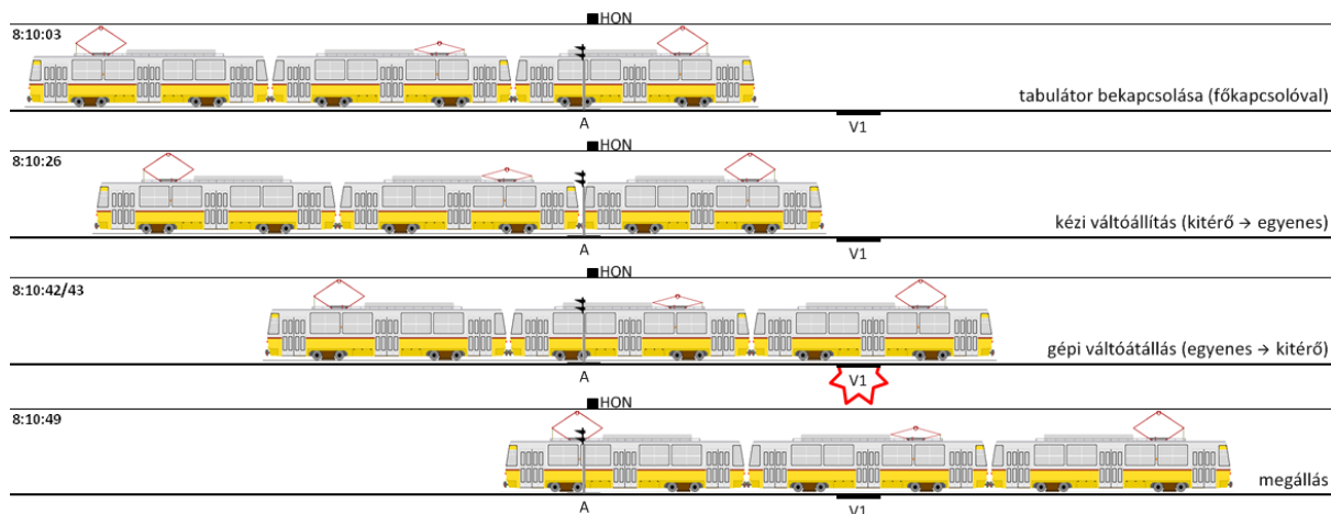
6. ábra: a villamos áramszedőjének és az áramszedő-érzékelő elemeknek a kölcsönös helyzete az esemény lefolyásának különböző időpillanataiban
