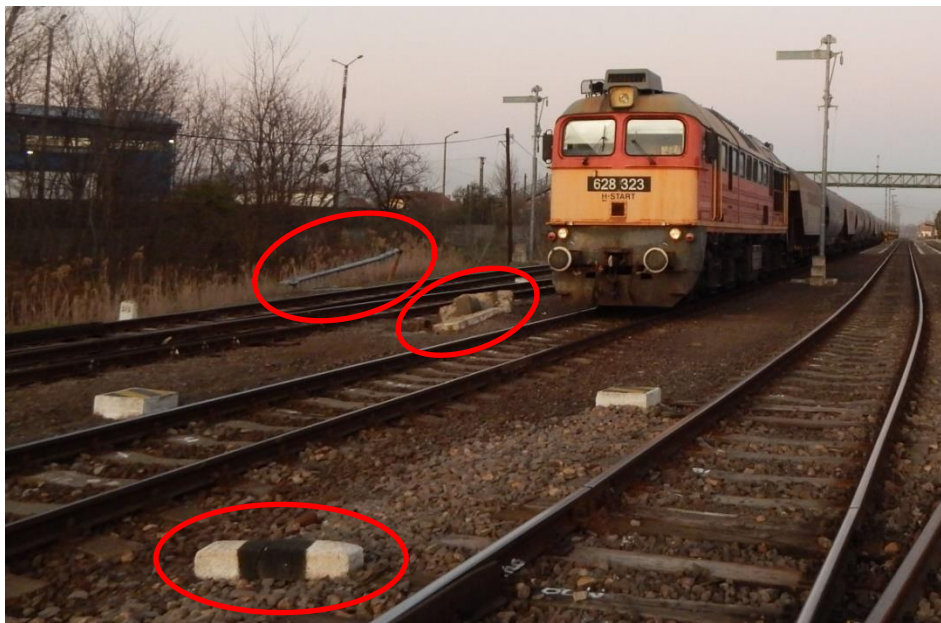
3. ábra: a II. és III. vágány között fekvő biztonsági határjelző, a „K3” jelű kijáratú jelző helye és a korábban kidöntött, vágányok mellé elfektetett alakjelző
