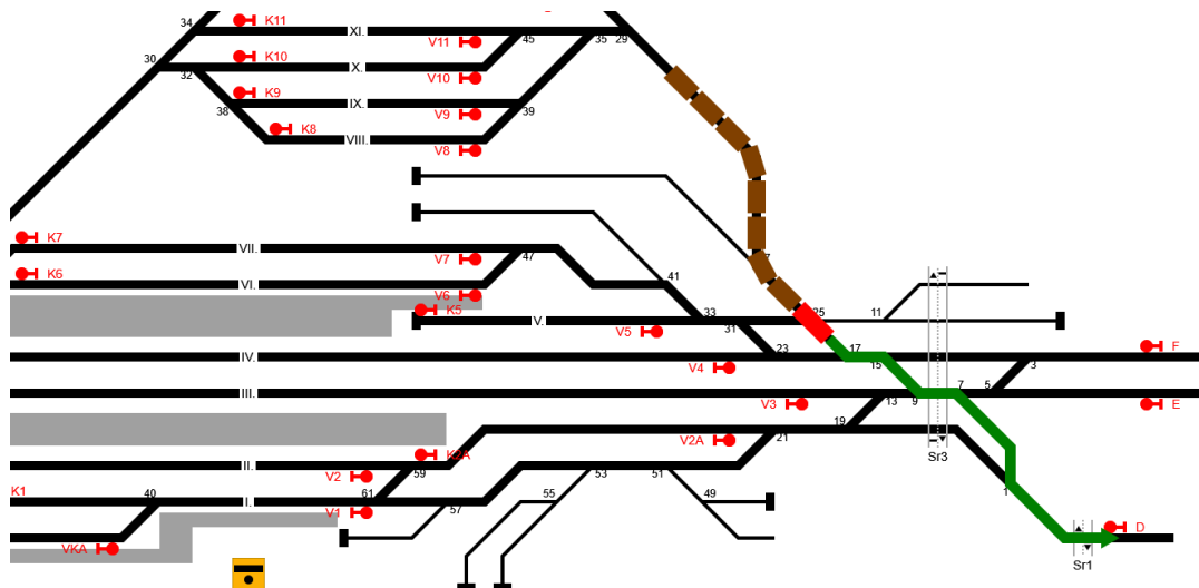
2. ábra: az állomás vágányhálózata és a vonat vágányútja
