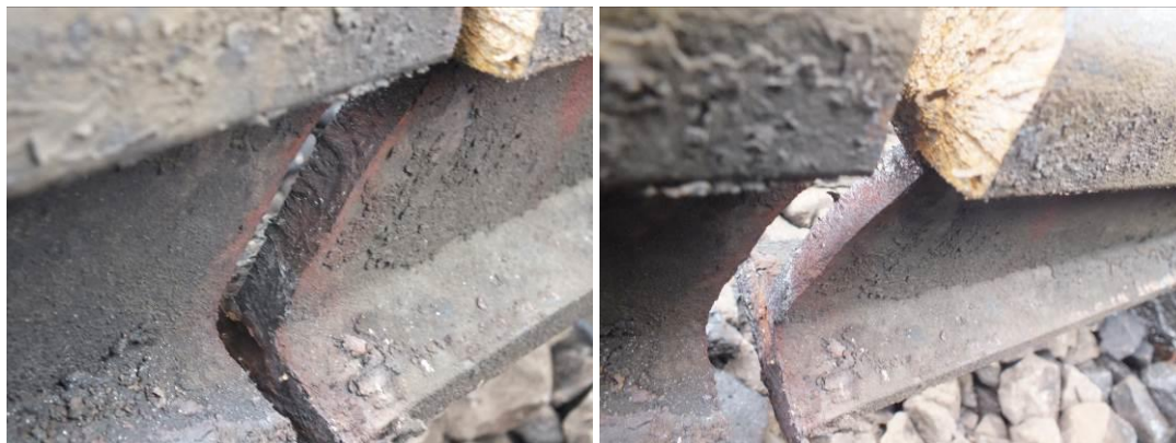
12. ábra: a baleseti helyszínen készített felvételek a törési felületről
