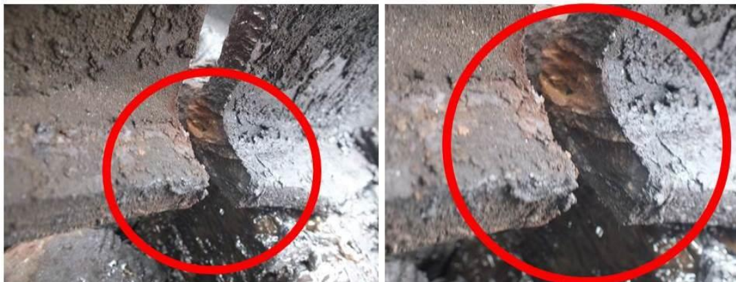
13. ábra: olajos szennyeződés a törési felületen
