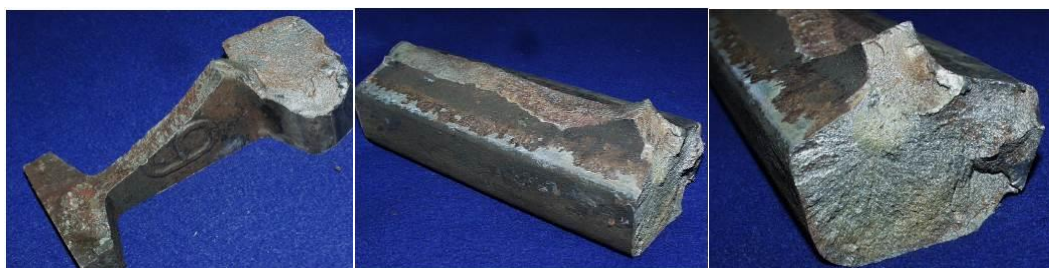
11. ábra: a megtisztított törési felület a makroszkópi vizsgálatához
