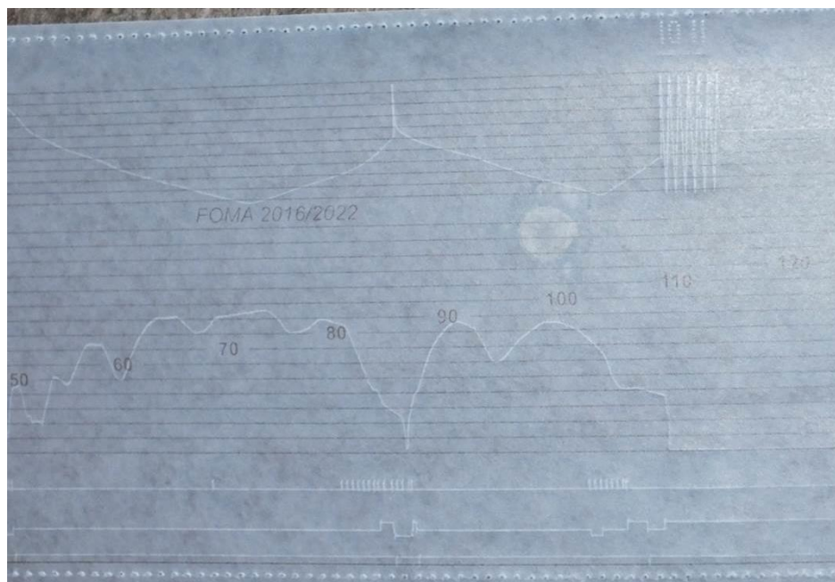
8. ábra: a 82901 sz. vonat mozdonyának menetíró regisztrátuma
