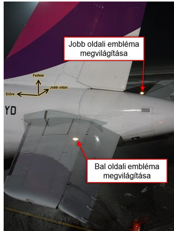
7. ábra: Embléma megvilágítás az A320 típuson
