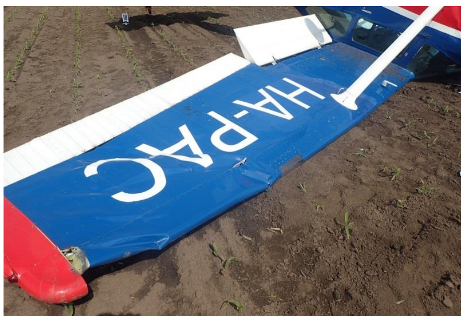
4. ábra: a bal oldali szárny sérülései
