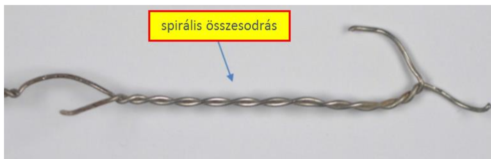
15. ábra: összehasonlítási célból felhasznált összesodort biztosító huzal (forrás: BEA)
