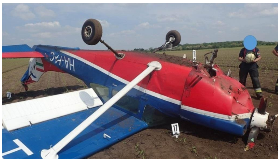
3. ábra: az orrfutó-, a törzs első rész-, a motorburkolat- és a légsavar sérülései
