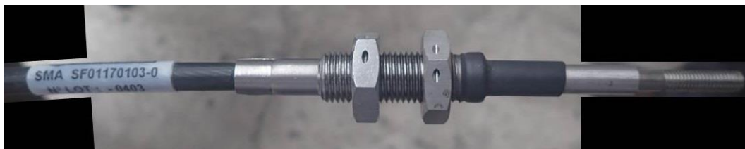
8. ábra: egy új üzemmód-átállító bowden adagolóhoz csatlakozó vége
