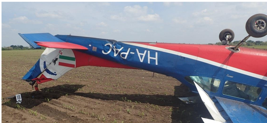
5. ábra: a törzs hátsó rész-, a függőleges vezérsík- és az oldalkormány sérülései
