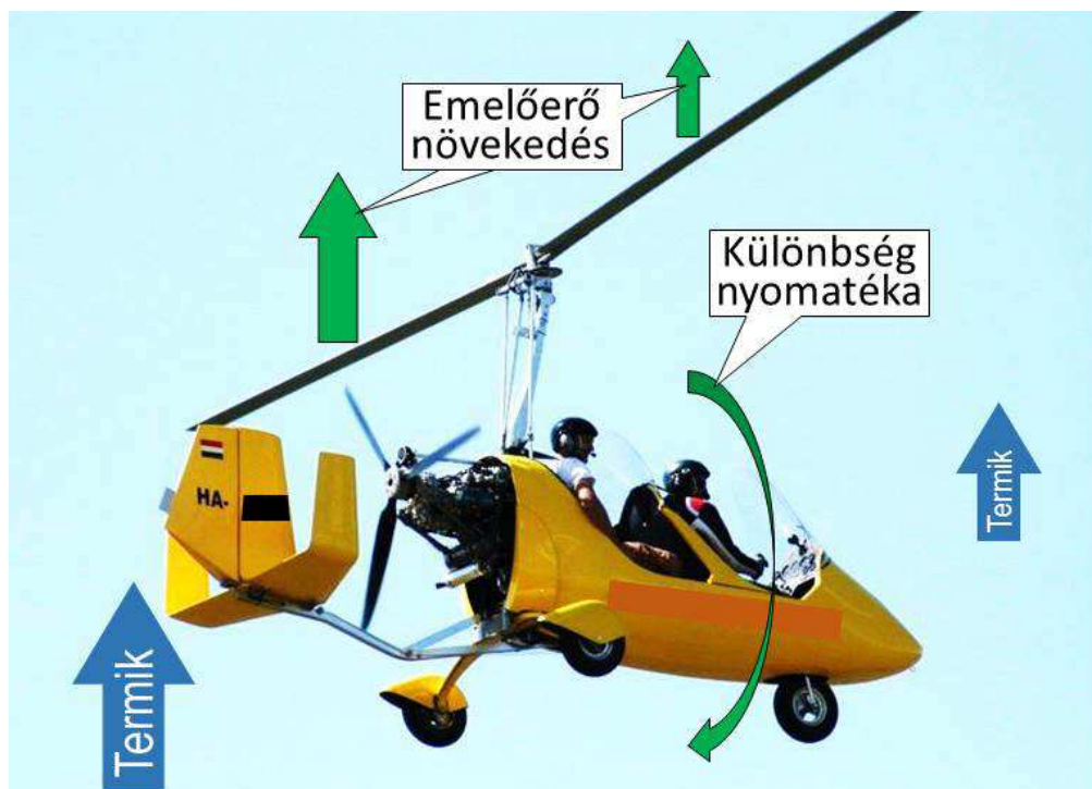
12. ábra: aszimmetrikus termik feláramlás nyomatéka.(illusztráció)
