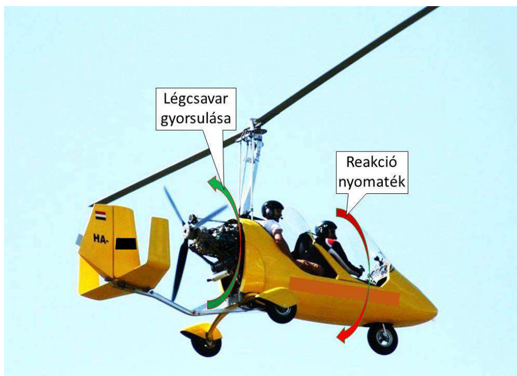
13. ábra: a légsavar gyorsulásából a légijárműre ható nyomaték.(illusztráció)
