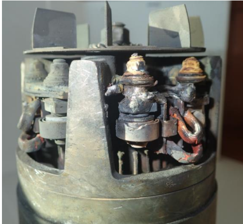
4. ábra Az elektromotor megégett alkatrészei
