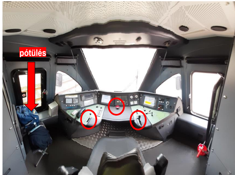
5. ábra: FLIRT motorvonat vezetőfülkéje, bekarikázva a mozdonyvezetői fékezőszelep (balra), a vészütőgomb (középen) és a menet-/fékkar (jobbra)
