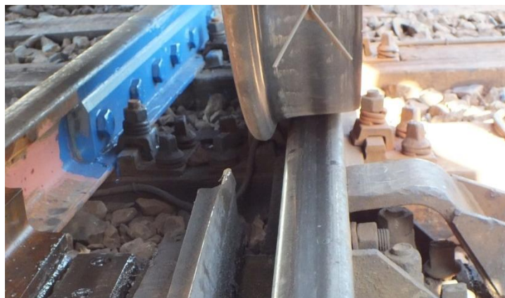
8. ábra: ütésnyom a csúcssín hegyén
