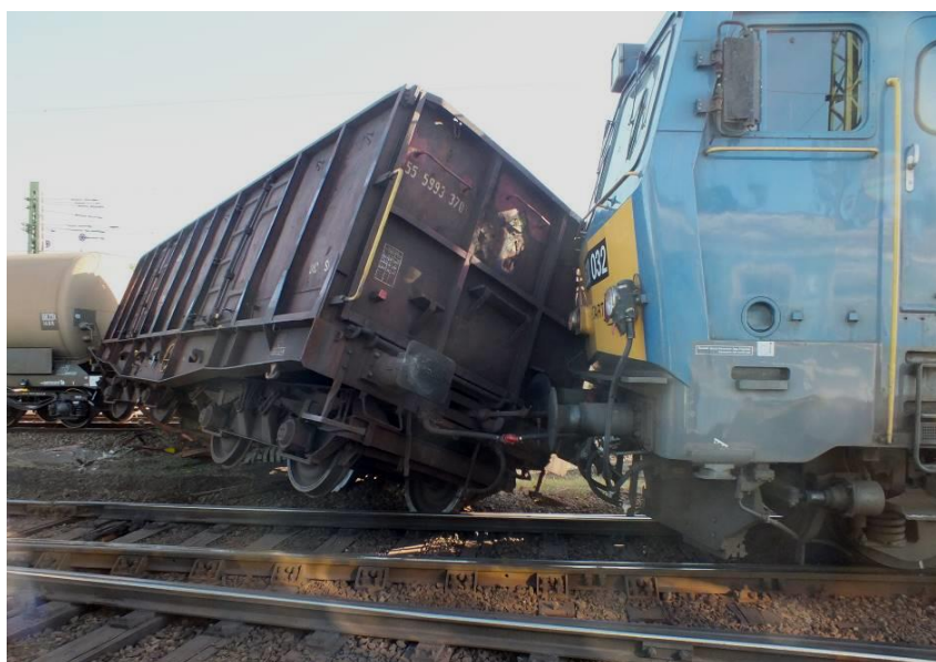
4. ábra: a kisiklott védőkocsi
