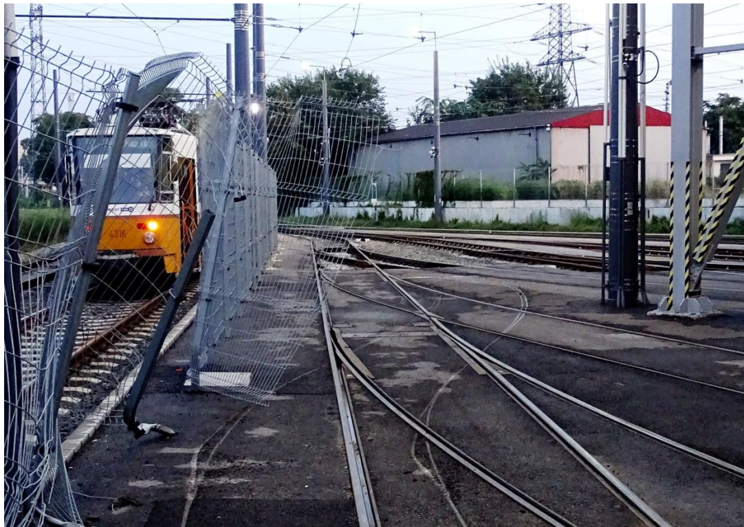
3. ábra: a forgalmi járat a megállás után, illetve a kisiklás nyomai és a kidöntött kocsiszíni kerítéselem
