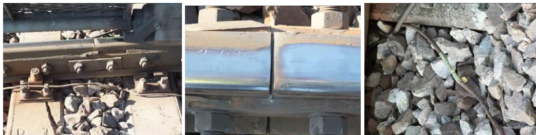
5. ábra: A szigetelt vezetékek és a szigetelt szakaszok közötti szigetelés állapota a 7. sz. váltónál
