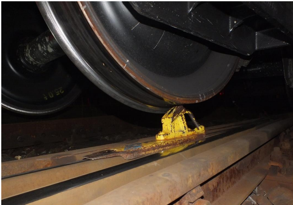
5. ábra: a keresztelési csúcsnál elakadt saru
