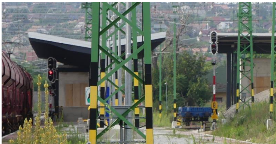
3. ábra: A K2 jelző fővörös és K1 jelző pótvörös fénye
