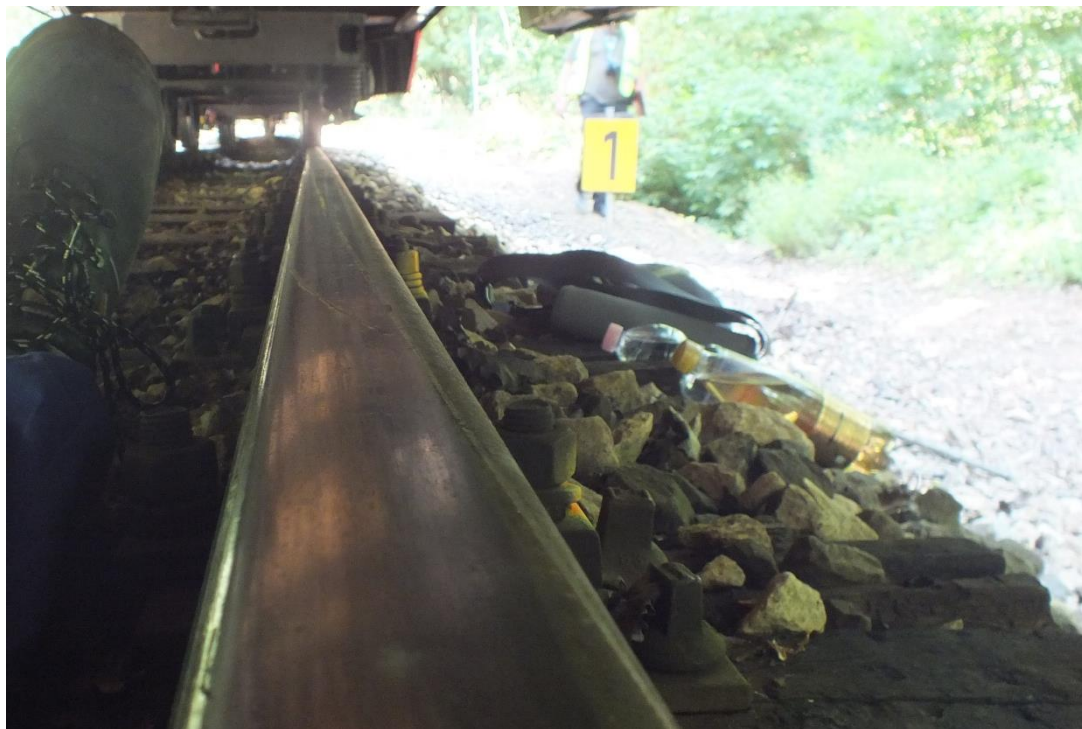
5. ábra: kisiklási nyomok, a menetiránynak ellentétesen nézve
