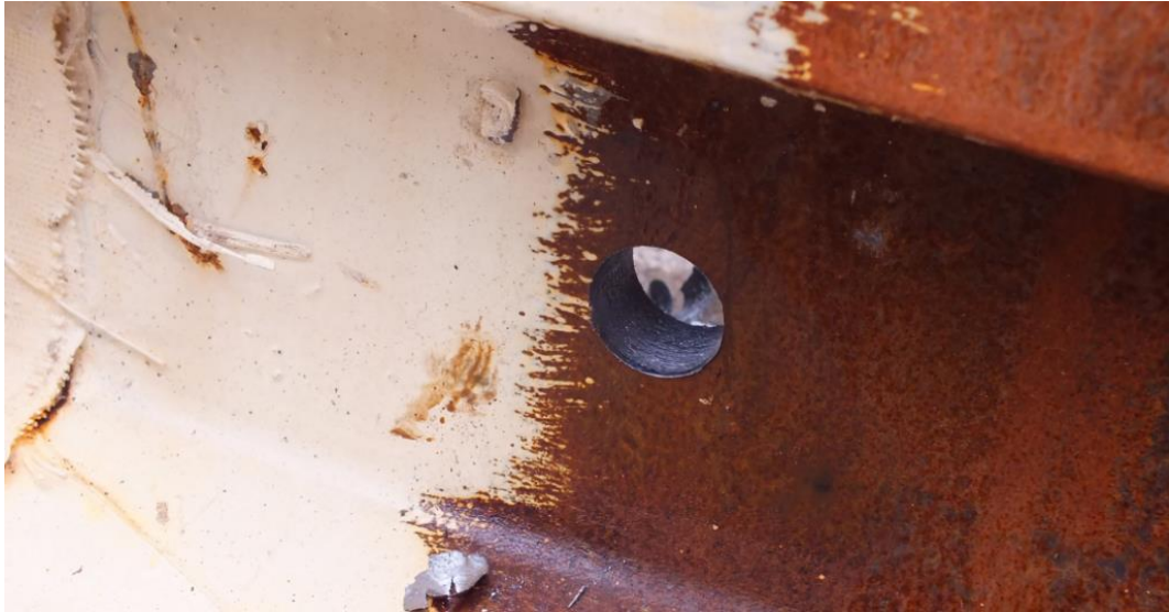
3. ábra: a balesetet szenvedett munkások által elkészített furat a fúrógép eltávolítása után
