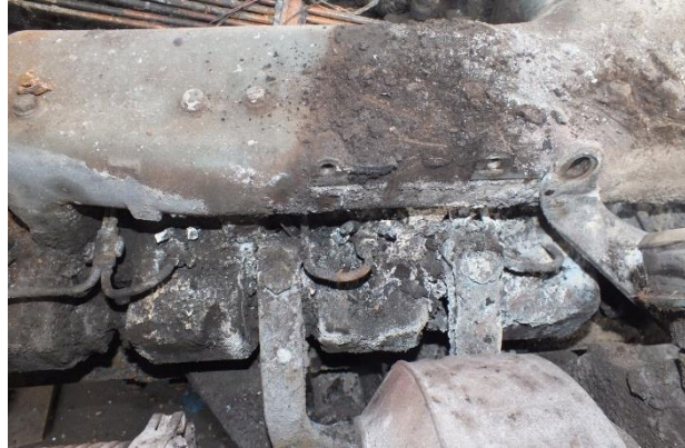
11. ábra: 3-4. hengernél égésnyom a turbófeltöltő mellett
