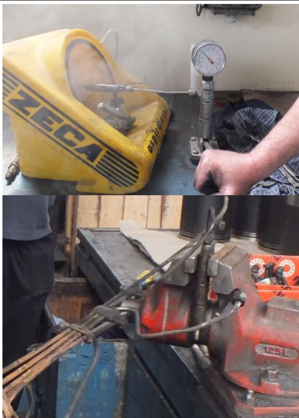
8. ábra: porlasztó és porlasztócső vizsgálata
