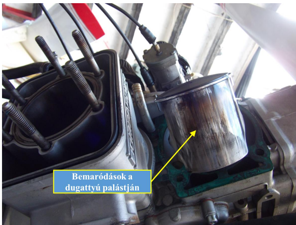
4. ábra: a 2. számú hengerből kiserelt dugattyú
