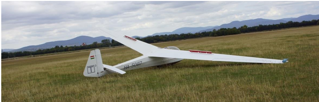
3. ábra: a vitorlázó repülőgép a megállást követően. A jobb oldali magassági kormánylap hiányzik
