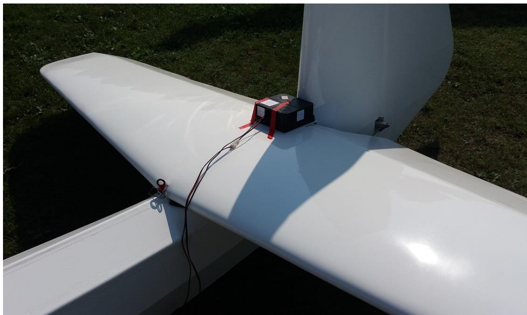
11. ábra: a gyorsulásmérő berendezés a gép farokrészén
