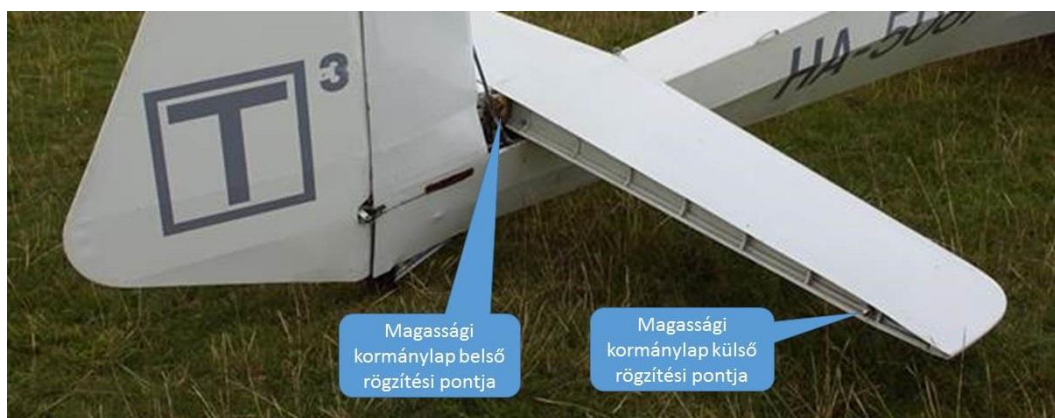
6. ábra: a jobb oldali magassági kormánylap rögzítési pontjai
