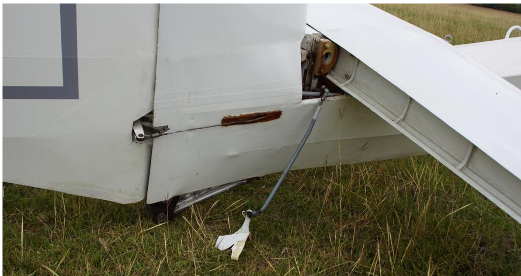
4. ábra: a jobb oldali magassági kormánylap hiánya a farokrészen
