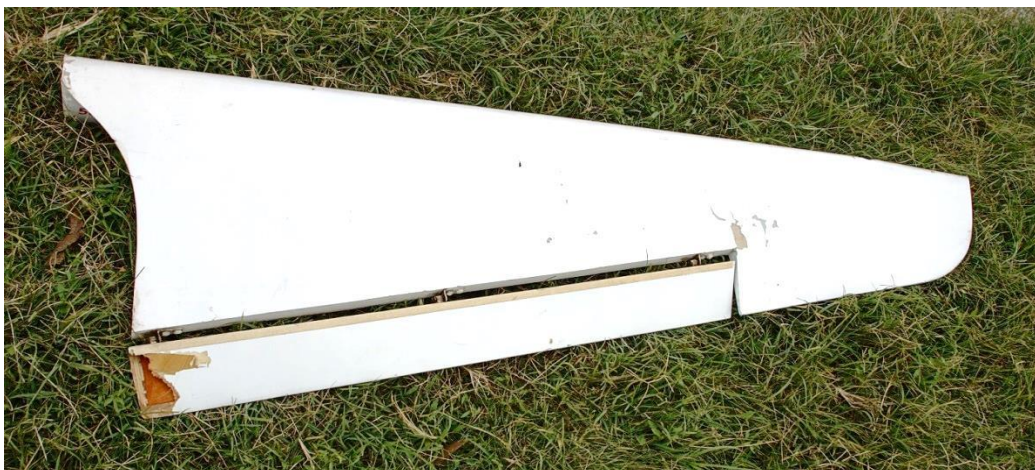
5. ábra: a jobb oldali magassági kormánylap és a trimmlap sérülései
