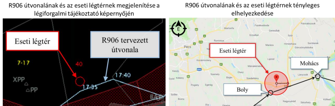
8. ábra: az R906 útvonalának és az eseti légtér megjelenítése a légiforgalmi tájékoztató radarképernyőjén és azok tényleges elhelyezkedése
