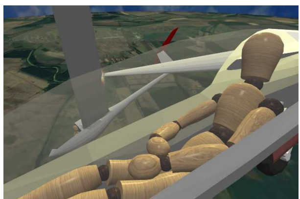
28. ábra: Az OK-7077-es bal szárny kilépő éle végigcsúszik a HA-4361-es belépő élén.
