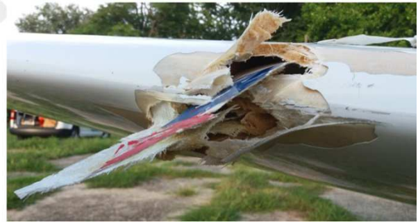
21. ábra: a szárnyba ékelődött kilépő él darab
