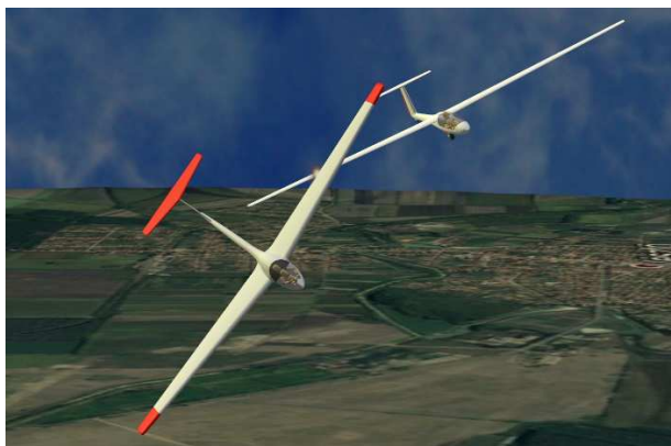
28. ábra: Az OK-7077-es bal szárny kilépő éle végigcsúszik a HA-4361-es belépő élén.
