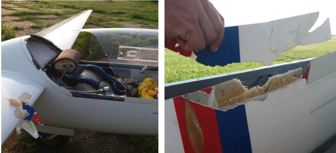
12. ábra: sérült kabintető és a szárnyba ékelődött kilépő él darab az OK-7077-ből
