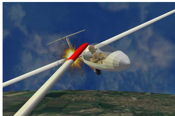
27. ábra: Az OK-7077-es bal szárnyvége a HA-4361-es belépő élével ütközik.
