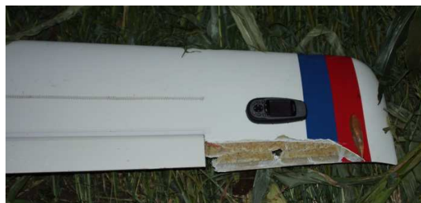
11. ábra: bal oldali szárny alja letört kilépő éllel
