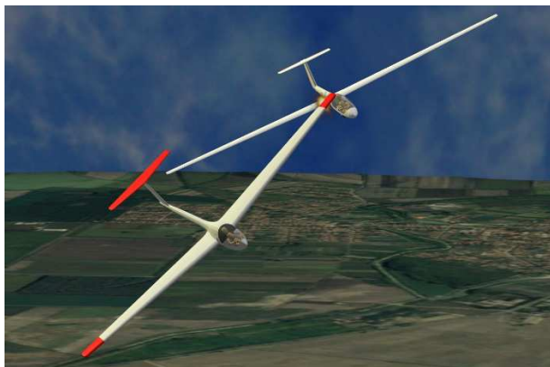
27. ábra: Az OK-7077-es bal szárnyvége a HA-4361-es belépő élével ütközik.
