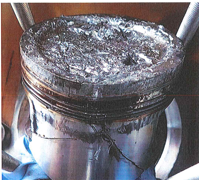
A meghibásodott henger dugattyújának sérülései
