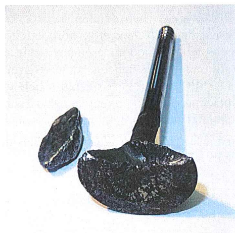
A törött kipufogószelep és a sérült hengerfej
