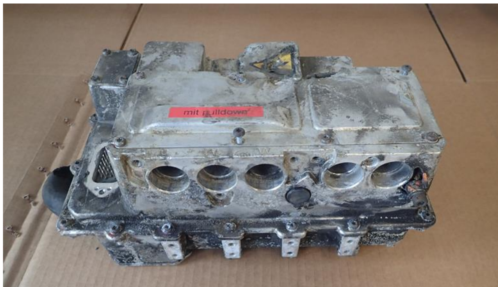
9. ábra: a légijármű invertere
