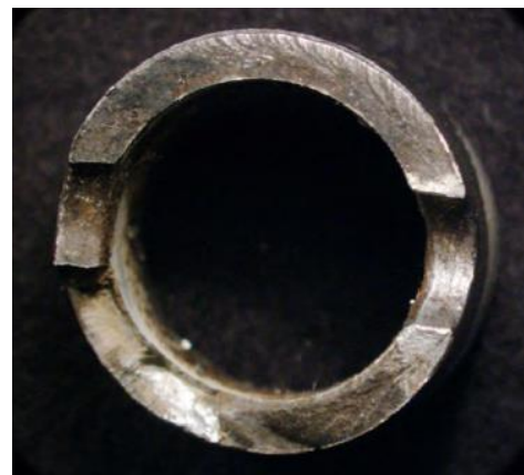
3. ábra: a futószár törési felülete
