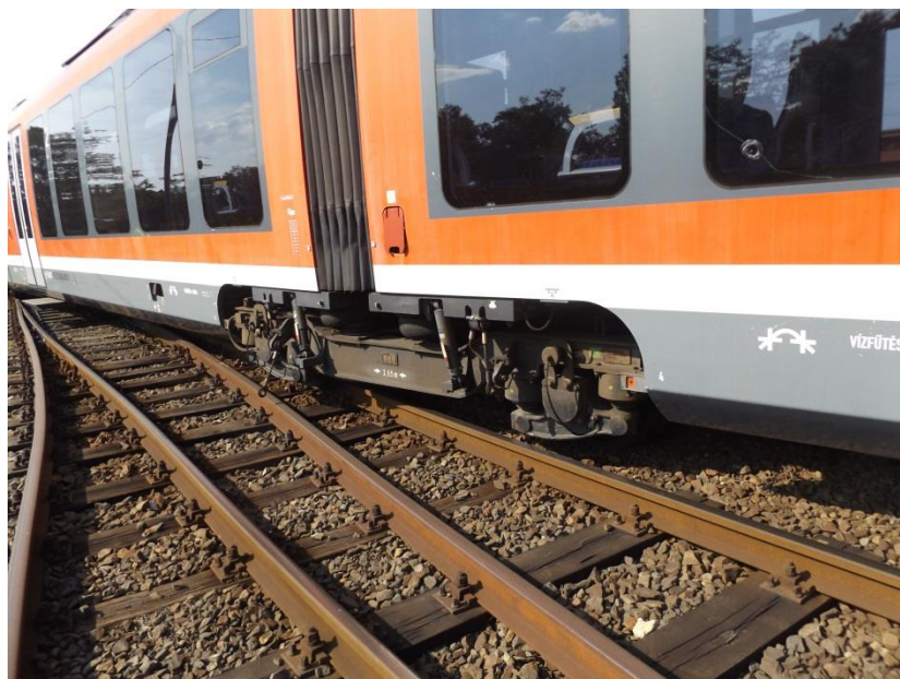
8. ábra: motorvonat kisiklott forgóváza
