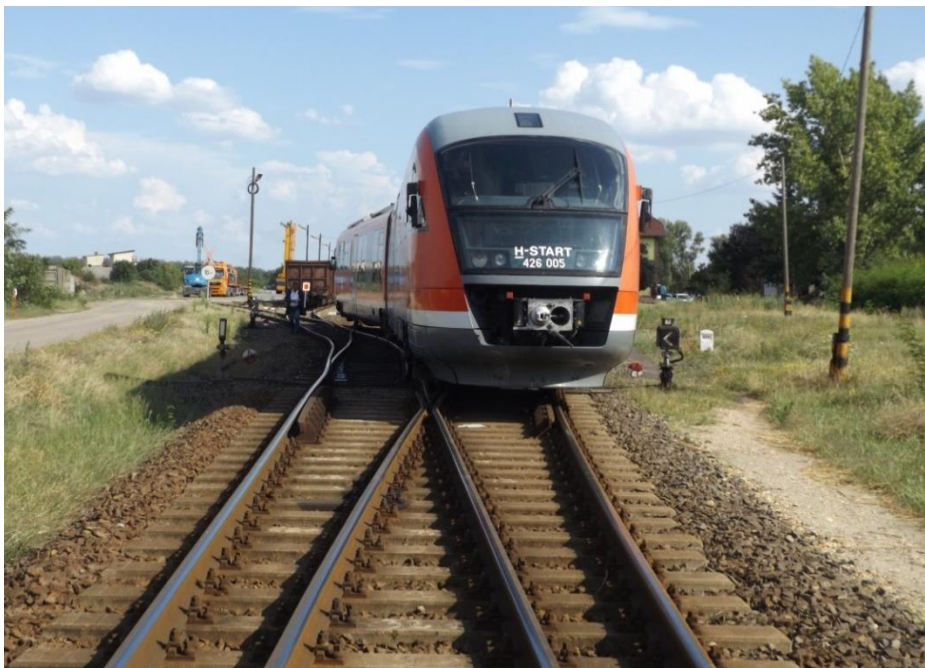
3. ábra: a kisiklott motorvonat
