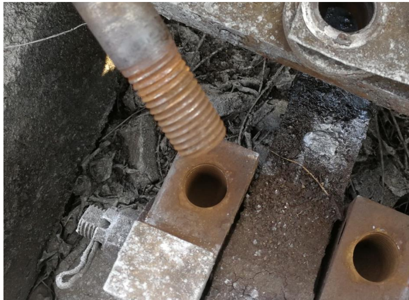
7. ábra: elhasználódott csavarmenetek
