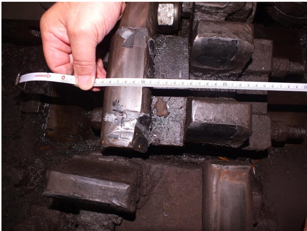
5. ábra: a közbenső rész váltója (üzemszerűen a fogaslécnek kellene folytonosnak lennie)
