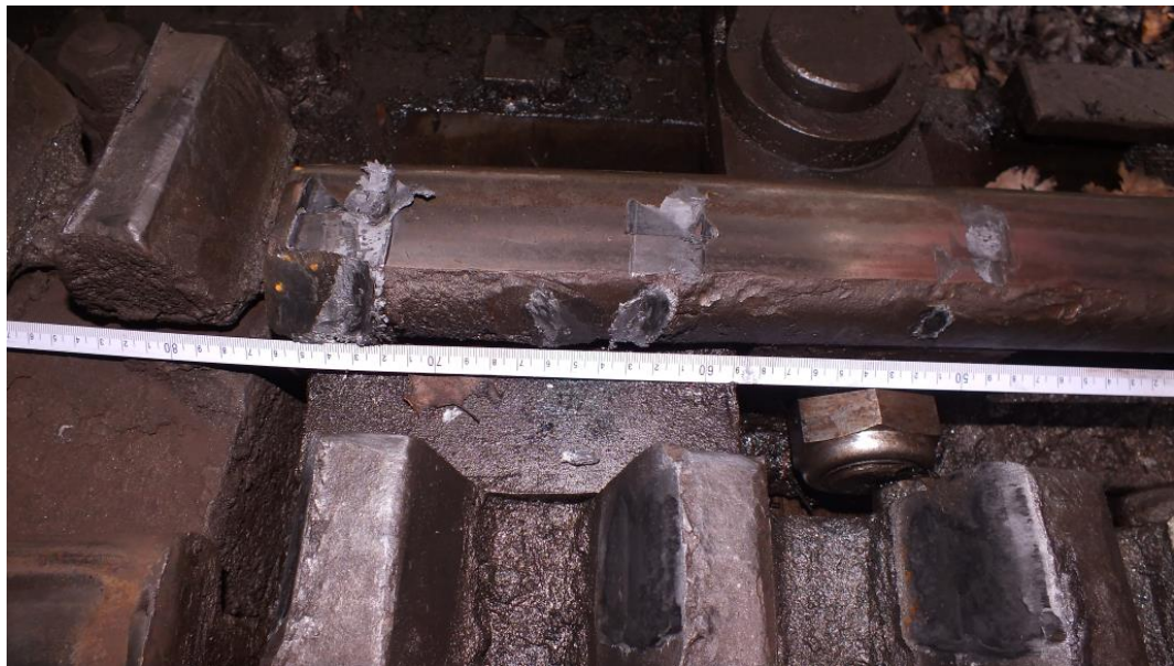
4. ábra: a kapaszkodó fogaskerekek nyoma a sínen
