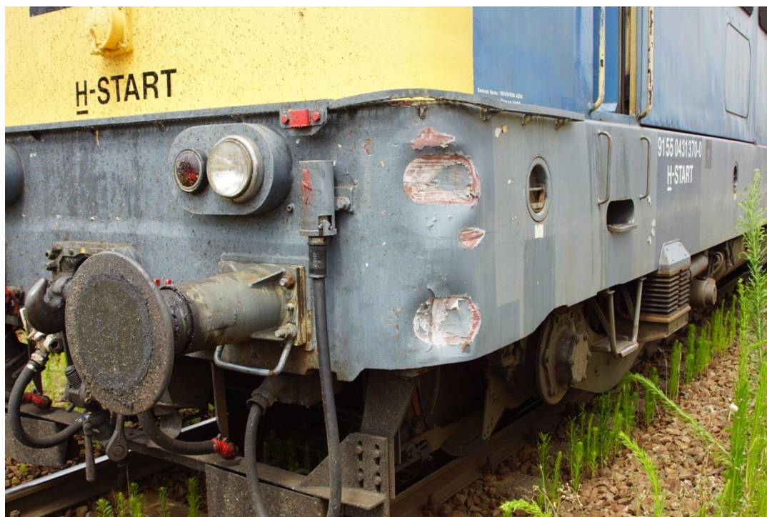
3. ábra: a mozdony sérülése
