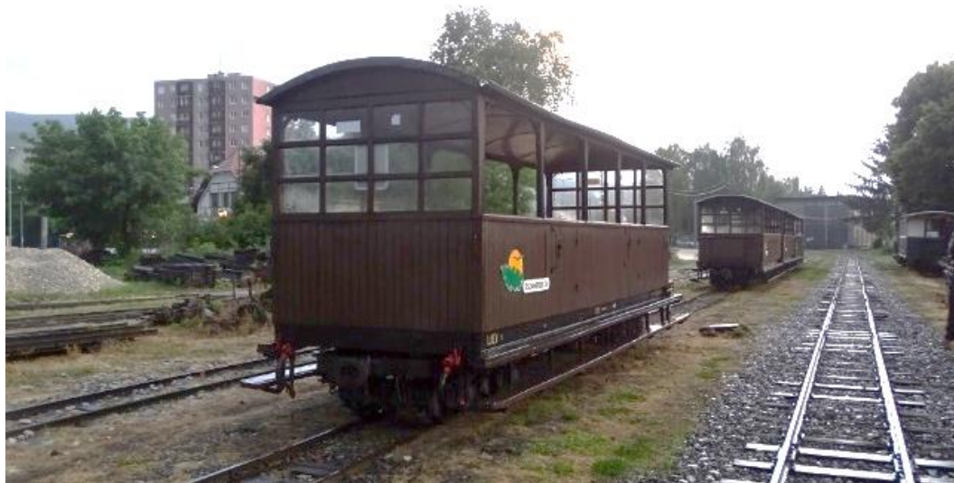
6. ábra: Majláth állomás III. vágányán leállított kocsik, alájuk tett saruk nélkül
