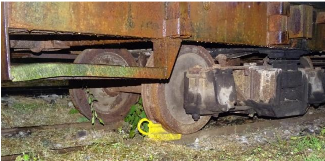
5. ábra. Majláth állomás III. vágányán hosszú ideje leállított romos teherkocsik biztosítása saruval
