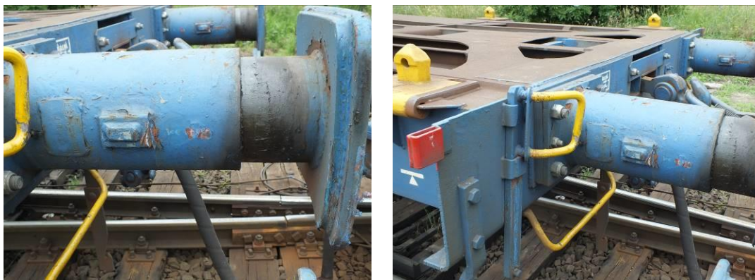
20. ábra: A kocsik egymásra torlódásának nyomai
