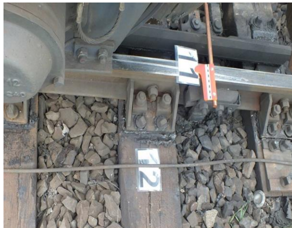
5. ábra: a 11. és 12. sz. nyom kettő tengely kisiklására utal
