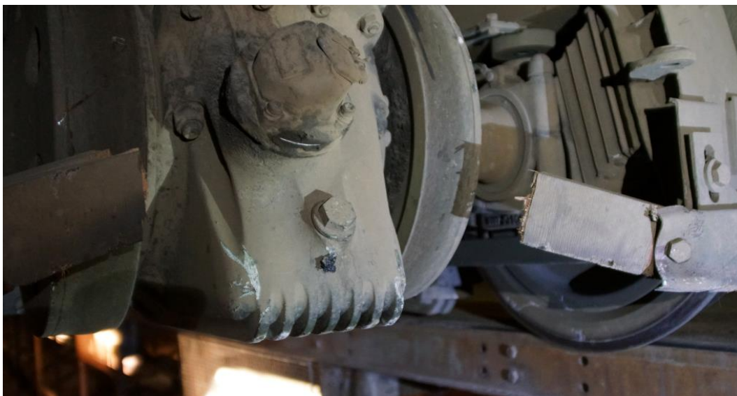
6. ábra: felakadt aszfaltdarab a tengelyhajtómű-házon
