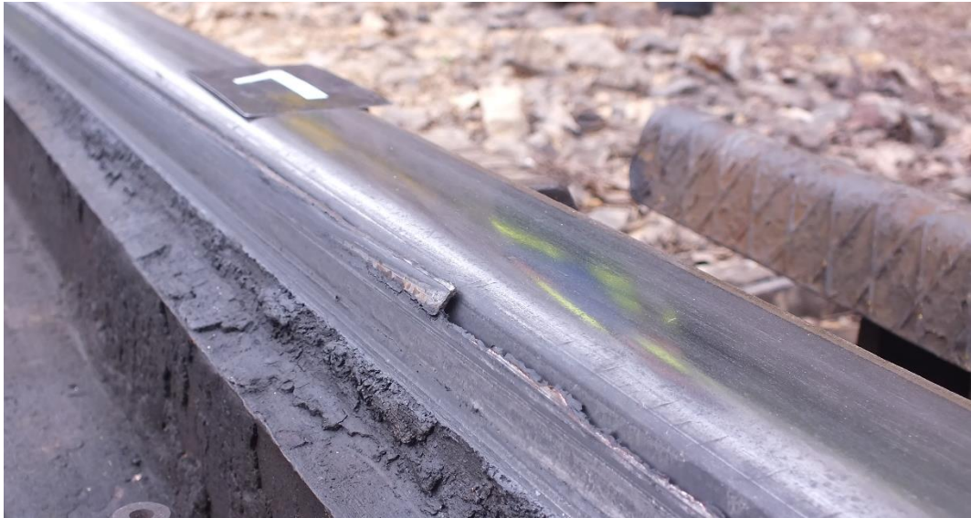
5. ábra: a csúcssín töredezett éle
