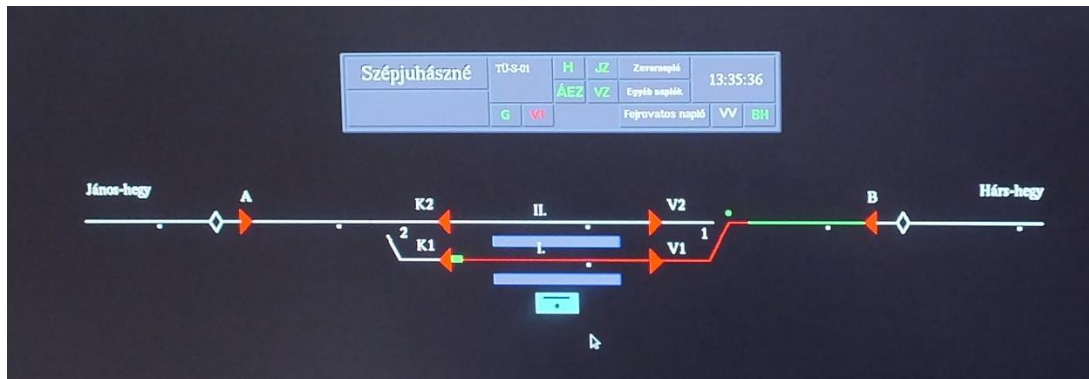
11. ábra: a biztosítóberendezés monitorképe az esemény után
