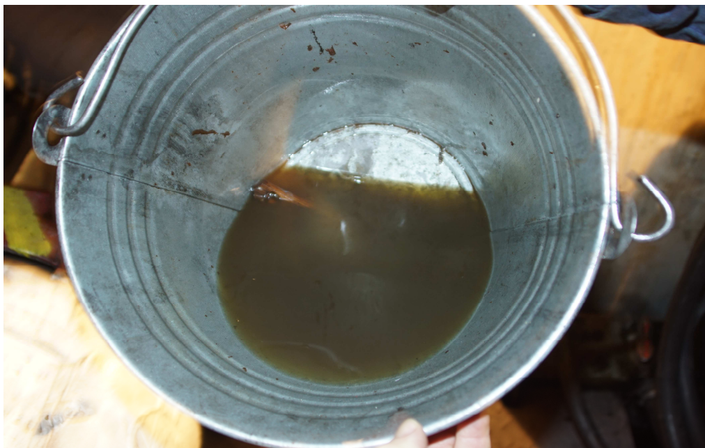
5. ábra: Az üzemanyagszűrő eldugulását okozó szennyeződés
