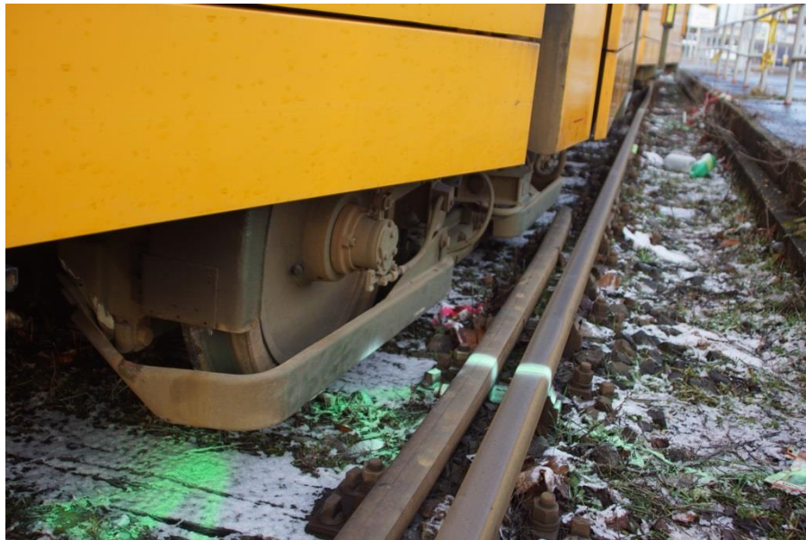
7. ábra: a villamos siklott forgóváza
